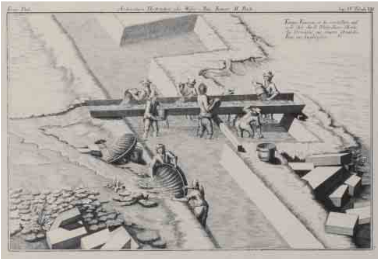
Fig. 35 Epuisement d'un canal à la main, ou «... comment on évacue l'eau d'une fouille à bras d'homme». D'après B. F. de Bélidor, 1740.
