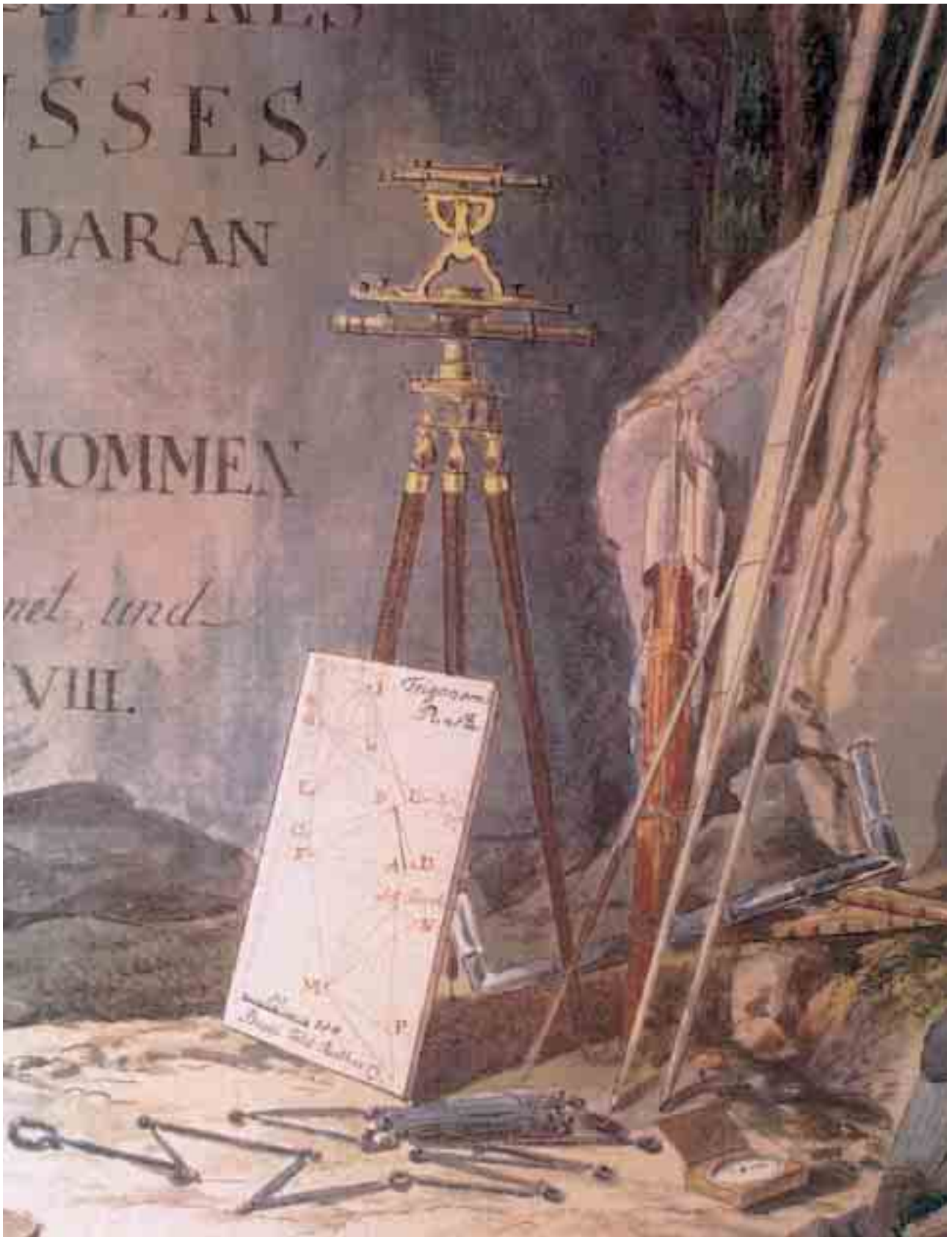
Fig. 22 Matériel utilisé lors d'une cartographie de la Birse en 1798: théodolite, chaîne d'arpenteur, latte, boussole, etc. (voir aussi RICKENBACHER 1999).
