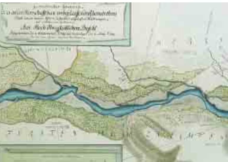
Fig. 87 Dignes offensives et arrière-dignes sur le Rhin à Haag. Sens de l'écoulement: de gauche à droite. Plan de H. C. Römer à l'intention des autorités de Sax, 1770.
