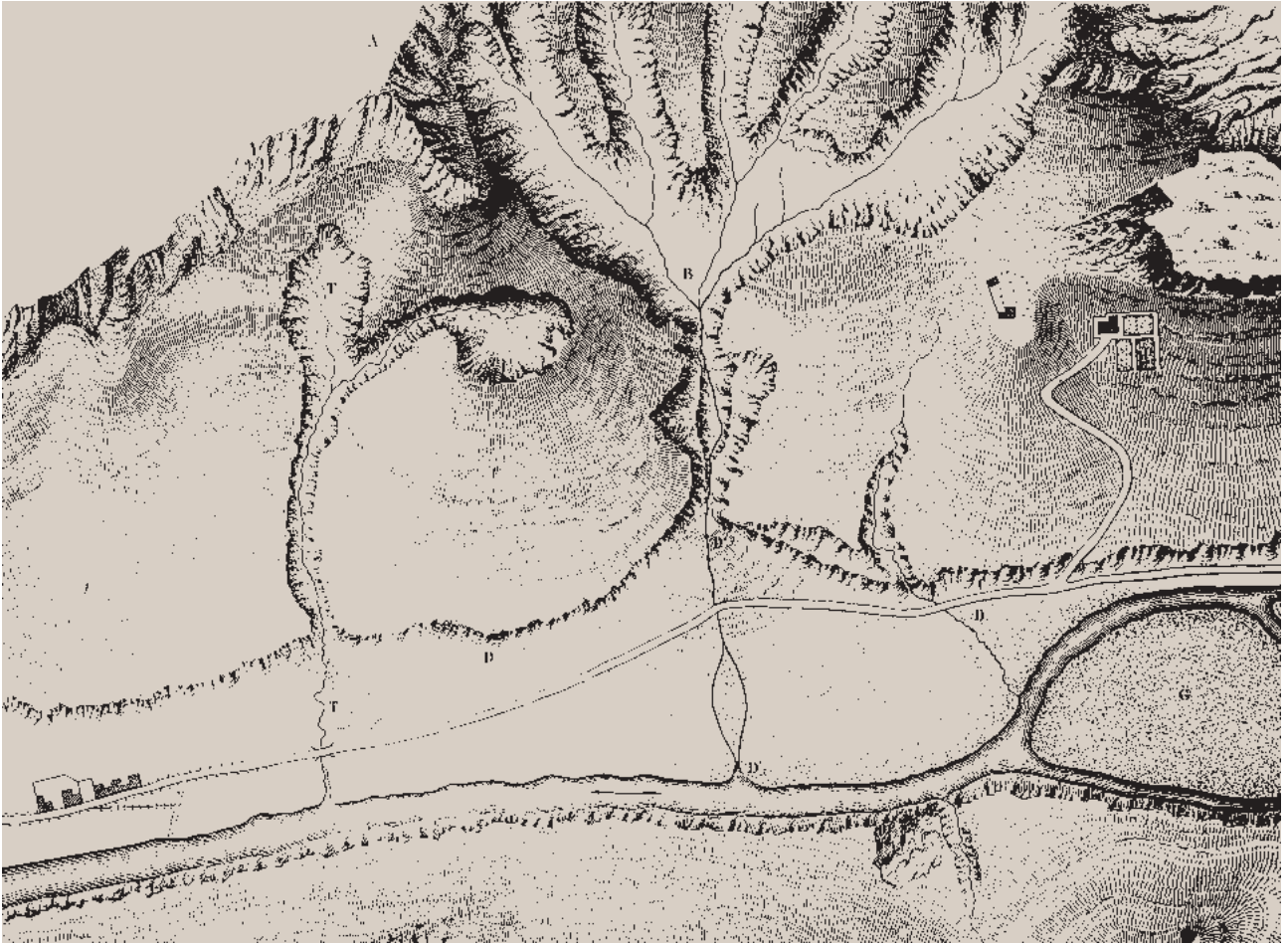
Fig. 147 Physionomie d'un torrent, avec le bassin collecteur, le chenal collecteur, le cône de déjection et l'émissaire, selon A. Surell, 1870.
