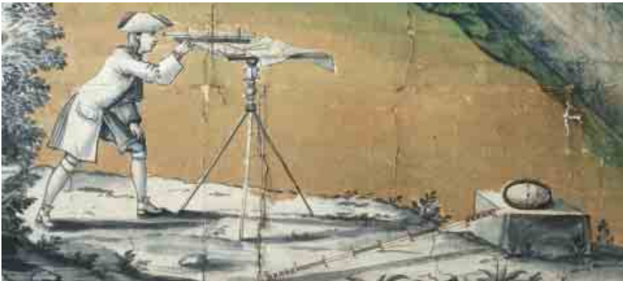
Fig. 26 Arpenteur utilisant une planchette et une alidade à Stein am Rhein en 1730.
